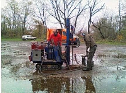
Im Rahmen des Hessischen Abschlussprogramms kommunale Altlastenbeseitigung werden in Mainhausen zurzeit verschiedene Altablagerungen untersucht. Dazu werden Bohrungen vorgenommen, die klären sollen, ob bei den Flächen Sanierungsbedarf besteht oder ob von den Flächen - meist ehemalige Müllablagerungen - keine Gefahr mehr ausgeht.
